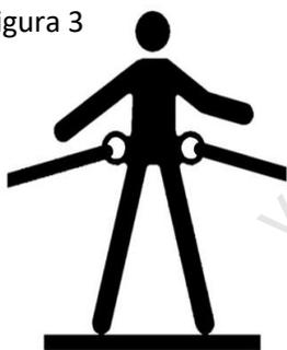
Arnés de cuerpo entero equipado con sistema para soportar al usuario en áreas de trabajo elevadas dispuestas de forma vertical, permitiendo el trabajo con las manos libres. “Las argollas laterales no deben ser usadas para detención de caídas y deben ser usadas en conjunto”.
